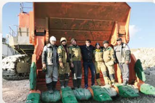
КОВШ ПРЯМАЯ ЛОПАТА ДЛЯ ЭКСКАВАТОРА HITACHI EX3600 ОБЪЕМ – 21 КУБ. М
