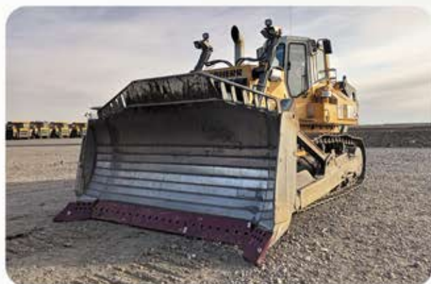
ОТВАЛ ПОЛУСФЕРИЧЕСКИЙ ДЛЯ БУЛЬДОЗЕРА LIEBHERR 784 ОБЪЕМ – 13,7 КУБ.М
