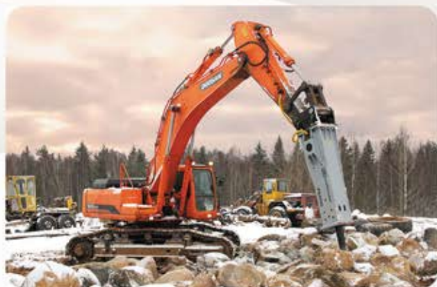
ГИДРОМОЛОТ PROFBREAKER PB450S ДЛЯ ЭКСКАВАТОРА DOOSAN 500LCV
