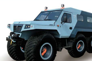
Хаски Грузоподъемность 2000 кг, Мест 8, Шины 1600x700-635
