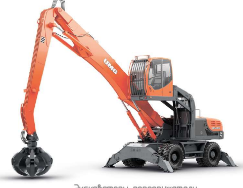
Экскаваторы-перезрыхлители Е 230 WH: 23,4 т, ЯМЗ 534, 132 кВт
