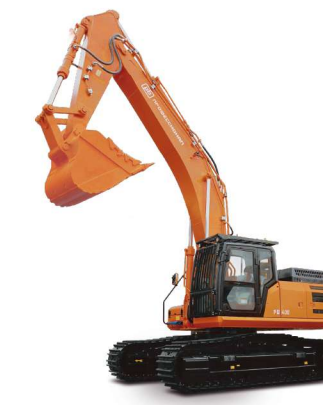
Экскаватор Профессионал PB400 Эксплуатационная масса 39,3 т Ковш скальный 1,9 м³ Двигатель Isuzu GH-6HK1/ DCEC Cummins 6L8.9-C325 (Tier 2) Номинальная мощность 212/241 кВт
