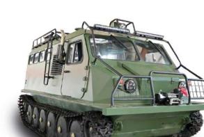
ГАЗ-3303-62 Грузоподъемность 2000 кг, Мест 13
