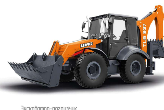
Экскаватор-погрузчик TLB827: 8,3 т, Perkins 1104C-44T, 68,5 кВт, TLB937: 8,8 т, Perkins 1104D, 74 кВт
