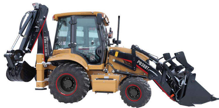
PB388T 8,9 т, Cummins, 48TA39-C100, 74кВт, Мосты и КПП Synchro Shuttle, пр-во Catpaga, Аккумулятор-парашейный насос, гидравлика HENK, SRS, 4WD
