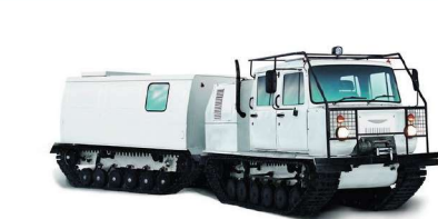
ГАЗ 3314 Грузоподъемность 3000 кг, Мест 17
