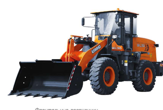
Фронтальные погрузчики WL 30: 10,5 т, Weichai 92кВт, 17 м³, з/п 3,0 м WL 50: 17,1 т, Weichai 162 кВт, 3,0 м³, з/п 5,0 м TL 165: 16,5 т, ЯМЗ 536, 140 кВт, 3,0 м³, з/п 5,5 м TL 165: 21 т, ЯМЗ 536, 191 кВт, 3,2 м³, з/п 6,5 м
