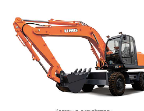
Колесные экскаваторы Е 170W: 17,5 т, ЯМЗ 534/93, 88 кВт, 1,0 м³ Е 185W: 17 т, Д 245, 77 кВт, 1,0 м³ Е 200W: 18,5 т, ЯМЗ 534/29, 119 кВт, 1,0 м³
