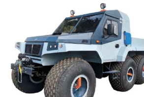
Веза Пикап Грузоподъемность 600 кг, Мест 4, Шины 1300x600-533
