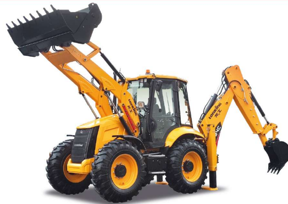
Lonking 84C 8,9 т, Weichai WP46100E220 74кВт, КПП Catpaga, Мосты Catpaga, Аккумулятор-парашейный насос, гидравлика BOSCH REXROTH
