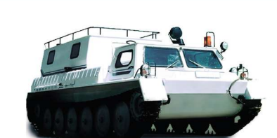
ГАЗ-3303-32 Грузоподъемность 1100 кг, Мест 10
