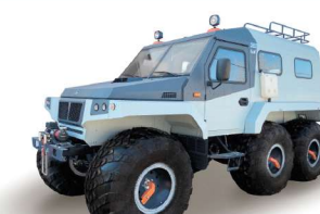
Веза Грузоподъемность 600 кг, Мест 8, Шины 1300x600-533
