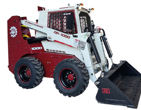
Мини-погрузчик собственного производства ПМ-1000. Грузоподъемность 1000 кг, емкость ковши 0,5 м³
